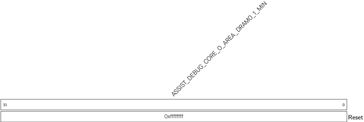
Register 19.29. ASSIST_DEBUG_CORE_O_AREA_DRAMO_1_MIN_REG (0x0018)
